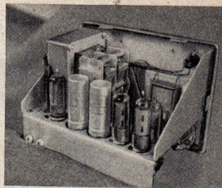
Bild 7. Rückansicht des Chassis. Hinten rechts ist die Netzdrossel zu erkennen, zwischen ihr und der Röhrengruppe ist eines der 60-V-Lämpchen sichtbar
